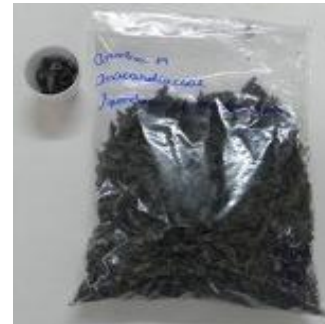
Foto 5: Aspecto da amostra após a primeira calcinação.
