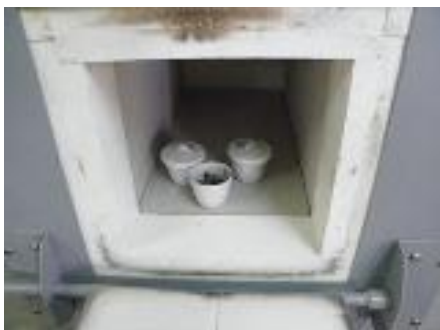
Foto 6: Material nos cadinhos pronto para segunda calcinação.
