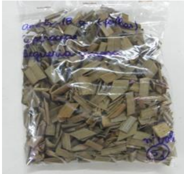
Foto 4: Amostras lavadas, prontas para a primeira calcinação.
