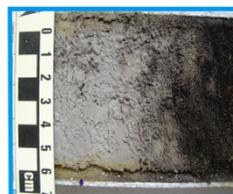
Contato erosivo entre pacote arenoso e o material argiloso responsável pela interrupção da sondagem
