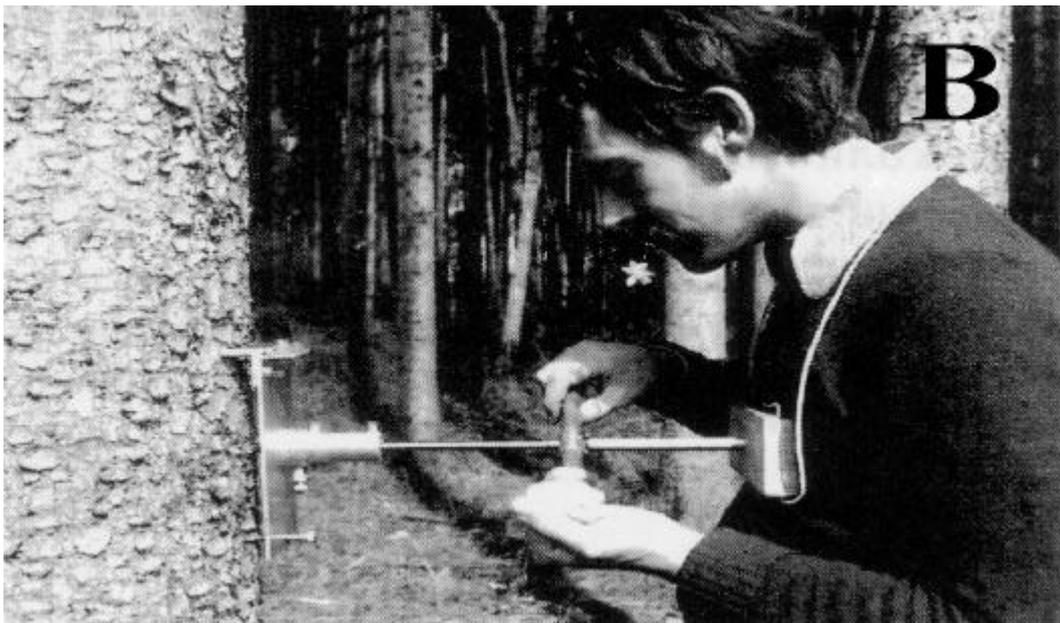
**Figura 2** - A - Partes componentes de um trado. B - Procedimento de amostragem.
